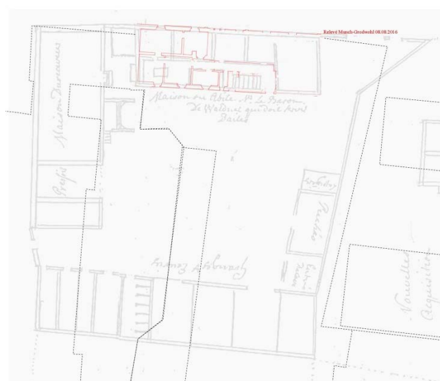
Figure 15. Superposition du plan historique et du relevé du rez-de-chaussée : il s'agit bien du même bâtiment
